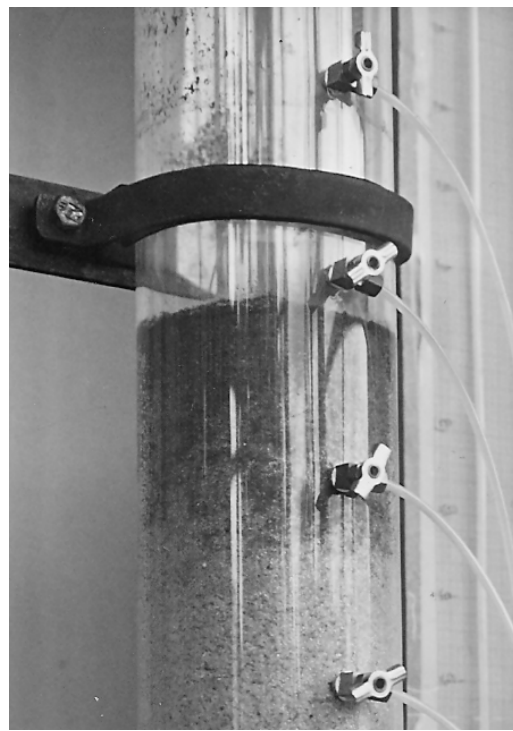
Obr. 8. Kolmatace filtru při filtraci suspenze vytvořené pomocí KPE
