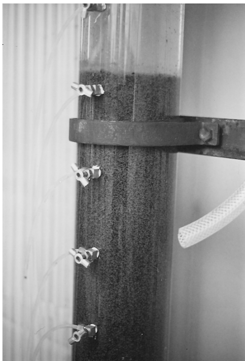
Obr. 7. Kolmatace filtru při filtraci železité suspenze
